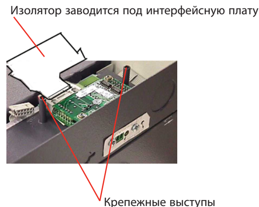
Рис. G-4. Монтаж изолятора
