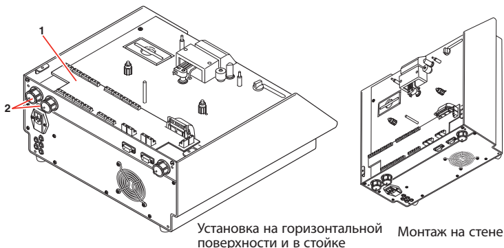
Рис. 3-10. Панель реле (крышка снята)
