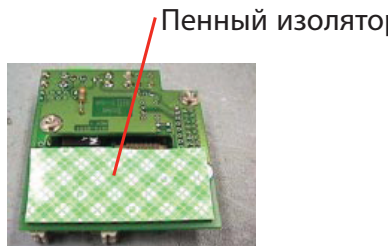
Рис. G-3. Установка пенного изолятора на интерфейсной плате LonWorks
